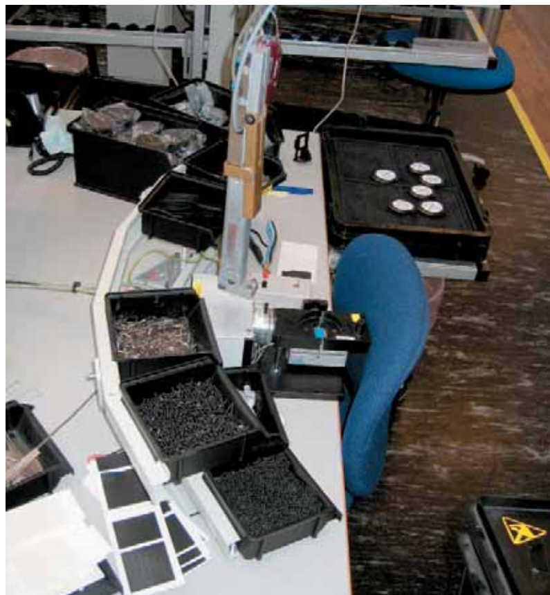
Et eksempel på anbringelse af komponenter inden for det optimale arbejdsområde.
