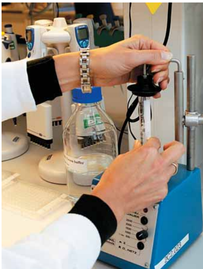
Hvirvelmikser forsynet med ekstraudstyr, som kan holde prøveglasset.
