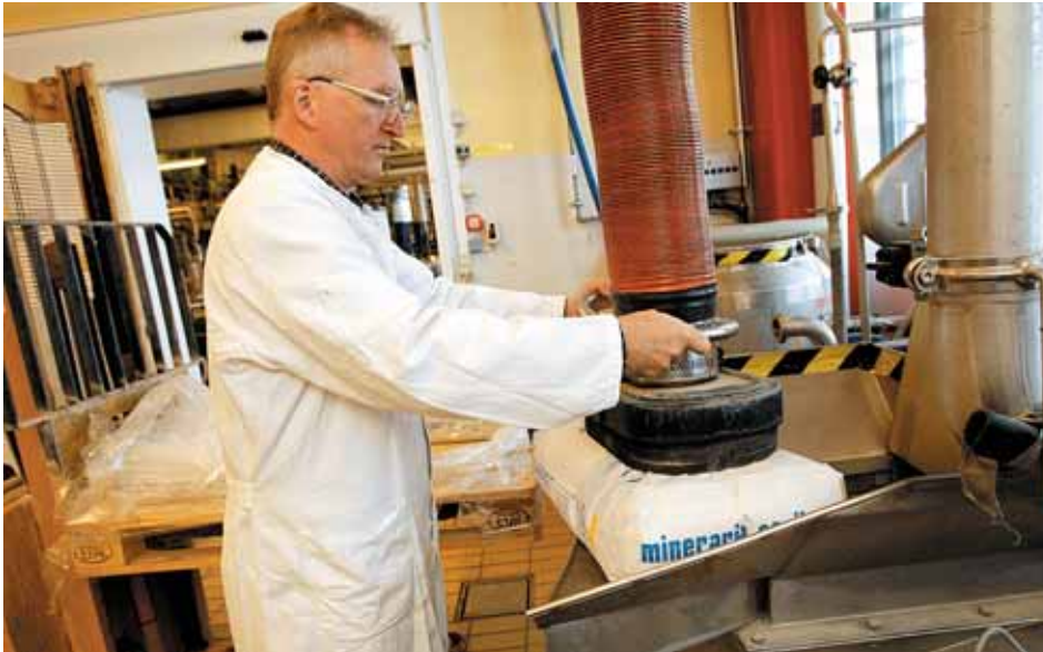
Vakuumløft som afhjælper et tungt løft.
