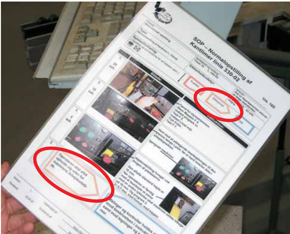
En illustrativ arbejdsprocedurebeskrivelse for en maskine – de røde cirkler viser, hvor der er sikkerhedsforskrifter
