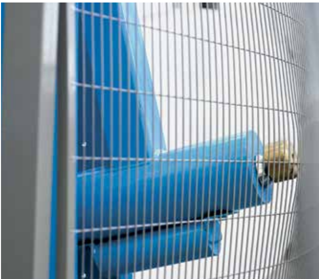
Hegnfabrikantens test af hegnets styrke i forhold til udslyngning af emner.
