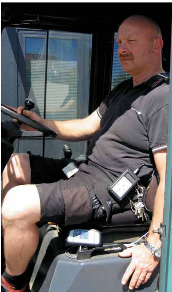
Støjbelastningen på førerpladsen måles ved hjælp af et støjdosisimeter med mikrofon placeret på skulderen.
