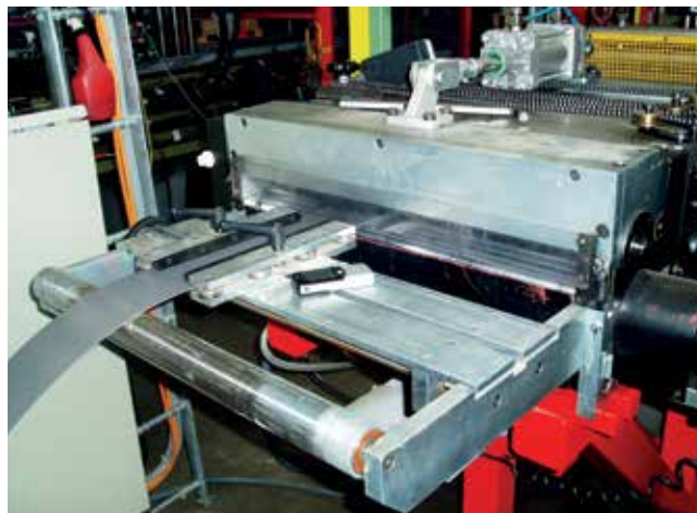
Valsesammenløb med tilstrækkelig afskærmning: Der er max 6 mm åbning i skærmen, så produktet kan komme ind, mens fingre ikke kan
