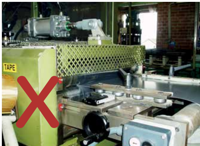
Valsesammenløb med utilstrækkelig afskærmning: Man kan række fingrene ind i et valesammenløb
