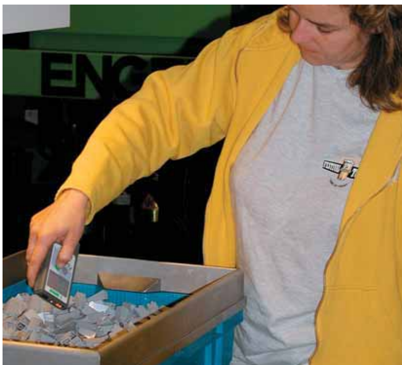
Måling af afledning af statisk elektricitet ved sprøjtestøbemaskine.
