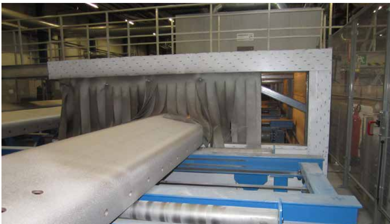
Overfladebehandling hos Andresen Towers
